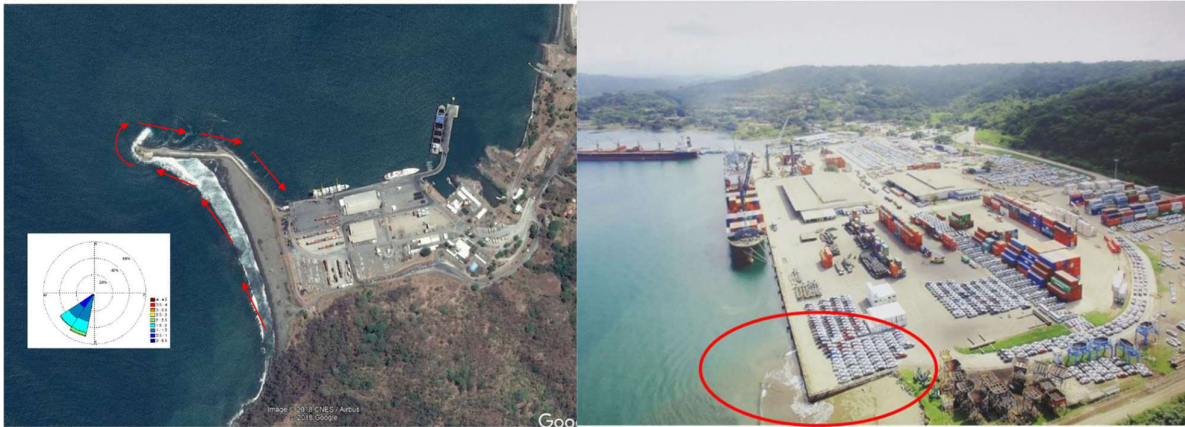
Figura 2-9 Problemática de sedimentación en las dársenas de puerto Caldera en la actualidad
